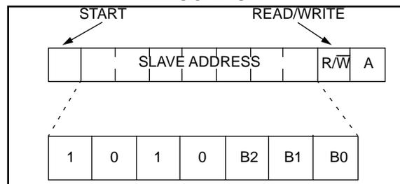
**FIGURE 4-1: BYTE WRITE**
